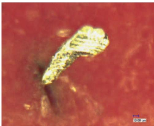
Abbildung 1: Metallsplitter, scharfkantig und zusammenhängend in der Beschichtung der Farbübertragwalze.
